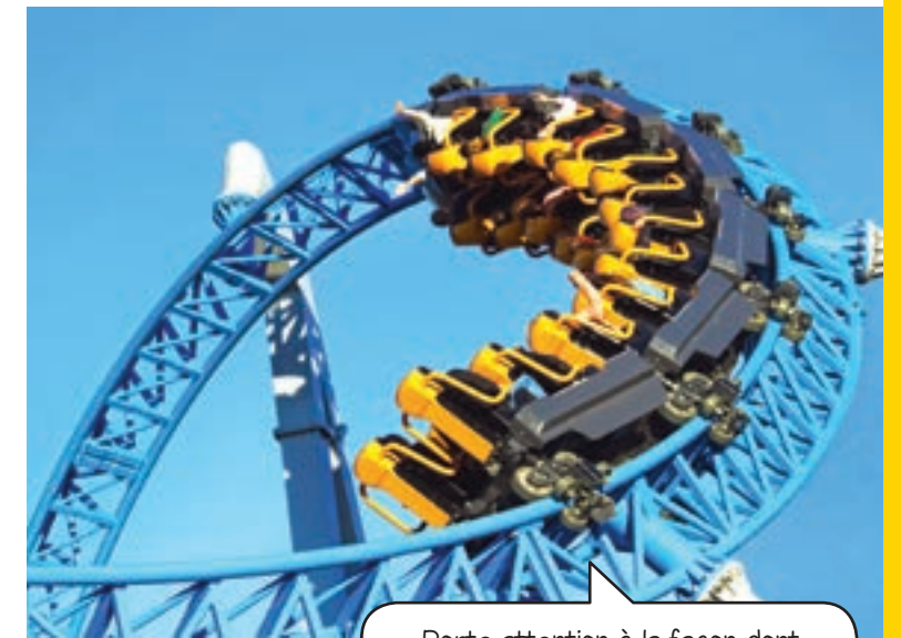
Porte attention à la façon dont les roues des wagons sont retenues au rail sur la photo ci-dessus.
